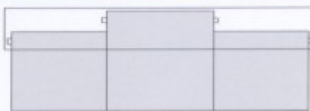
Podwójna kasetka kurtyny z wałami na różnych wysokościach. Szerokość 150 mm x wysokość 250 mm.
